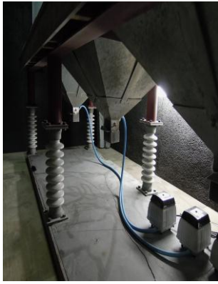
三角のところに原料を入れ電子をチャージしています
